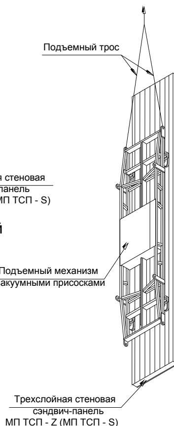
Схема строповки при вертикальной раскладке сэндвич-панелей
